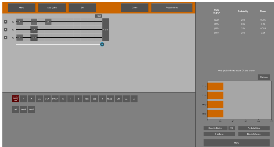
Figure 5: Dissenyador de circuits, podem veure el circuit amb els diferents qubits (cada línia horitzontal correspon a un qubit), a la dreta el panell de probabilitats i a baix el panell de portes.
